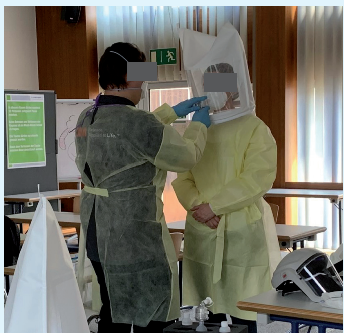
Abbildung 2: Fit-Test mit Einsprühen von Saccharose in die Haube Fotos: W. Popp, HyKoMed
